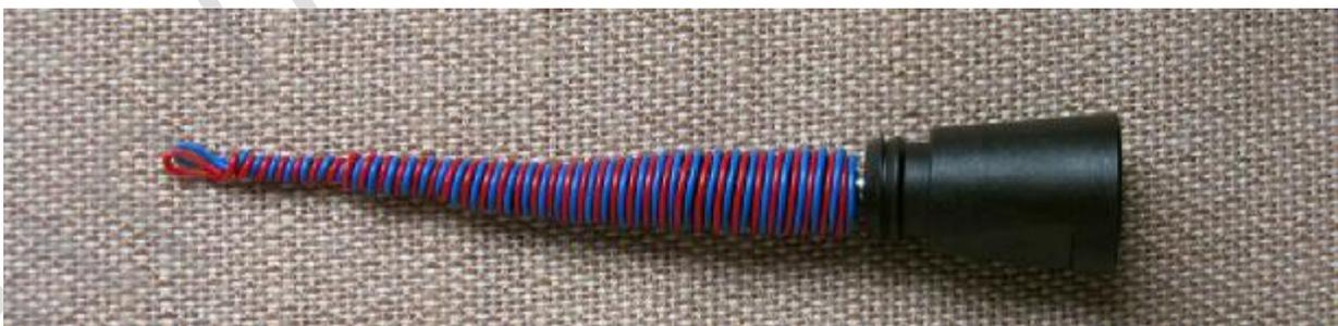
Vor dem endgültigen Wiederverschließen des Antennengehäuses ist es ratsam den Fuß einmal offen ans Fahrzeug zu schrauben um das Resultat zu überprüfen. Jedes Öffnen und Schließen belastet die Kunststoffkanten der Ringnut. Es ist ohnehin ratsam die Antenne bereits nach einmal Öffnen, vor Durchfahrt einer Waschstraße abzuschrauben.
