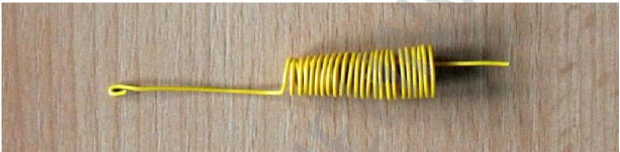
Die Funktion ist jedenfalls bei beiden Varianten gegeben. Vor dem Lötten sollte noch die Passform der Spirale im Hohlraum des Antennengehäuses überprüft und gegebenenfalls korrigiert werden. Dabei daran denken, dass der Fuß noch etwas in die Hülle eintaucht.
