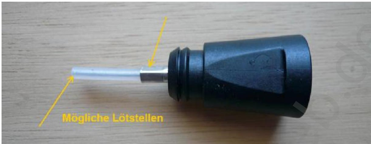
Zum Löten am Ende des Antennenstumpens, wird dieser selbstverständlich abisoliert. Wenn die Lötstelle fertig ist, sollte diese jedoch mittels Schrumpfschlauch oder Isolierband wieder isoliert werden. Wenn man nun den unteren Teil der Drahtspirale geschickt über den Leitungsstummel des Antennenfußes stülpt, sollte die Sache auch wieder zusammenpassen.
