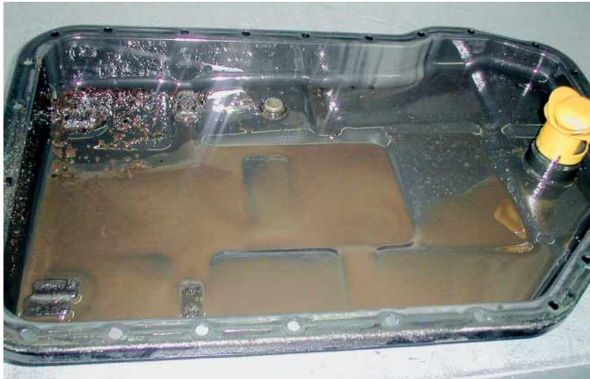
**Reibungsverluste:** Späne im Automatikgetriebeöl weisen auf einen mechanischen Defekt hin. Nach dem Austausch des Automatikgetriebes sollten auch der Ölkühler erneuert und die Ölleitungen gespült werden. Bild: STR-Automatikgetriebe
