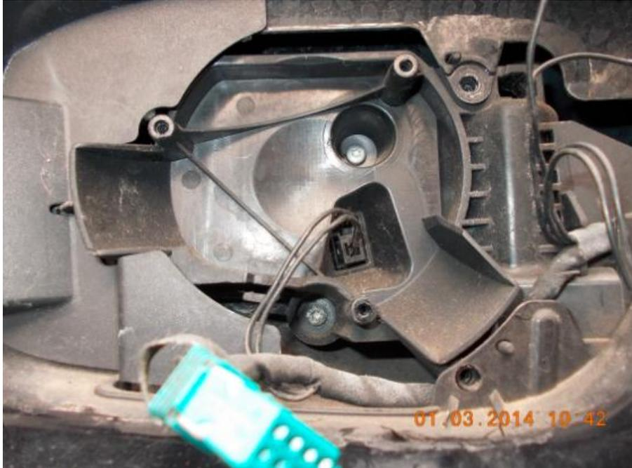
Durch den Ausbau der linken inneren Abdeckung (ist nur eingerastet) kommen noch 2 weitere Torx T10 Schrauben zum Vorschein, welche auch die vordere Verkleidungsschale halten (es sind also insgesamt 4 T10 Schrauben).
