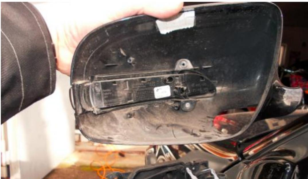
Am Fahrzeug verbleibt der Spiegelträger mit dem elektrischen Anschluss für den Anklapp-Motor.
