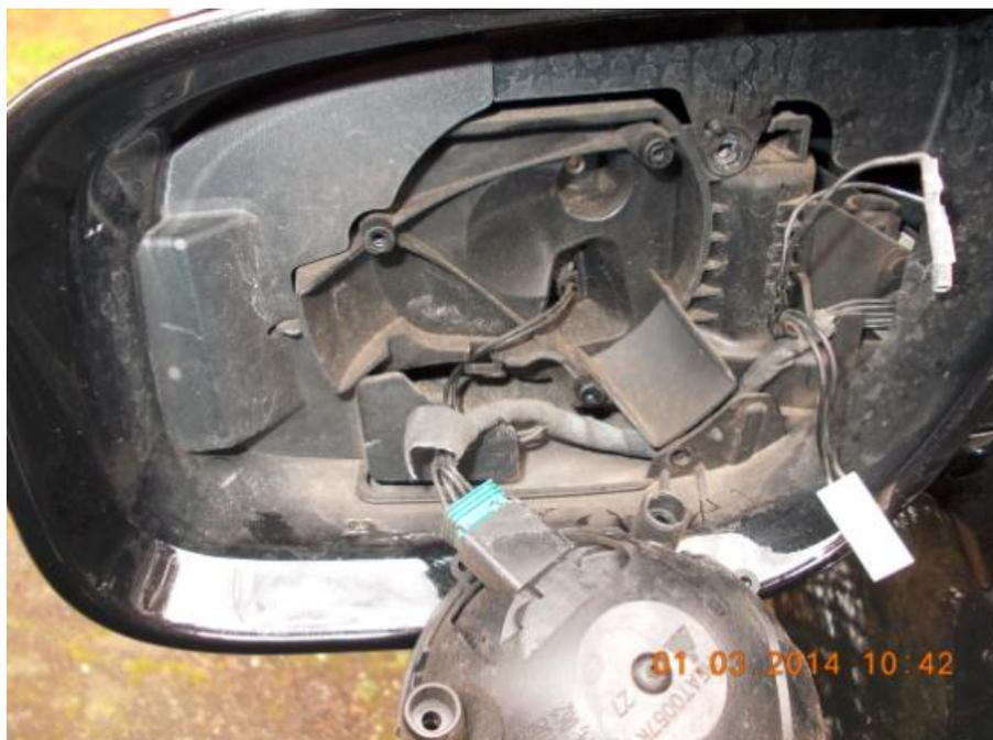
Auf dem nächsten Bild sieht man nochmal hinter dem bereits ausgebauten Motorträger die beiden Torx T10 Schrauben, welche den Blinker und die vordere Verkleidungsschale halten. Auch der schwarze Stecker von der Blinkleuchte ist schon sichtbar.
