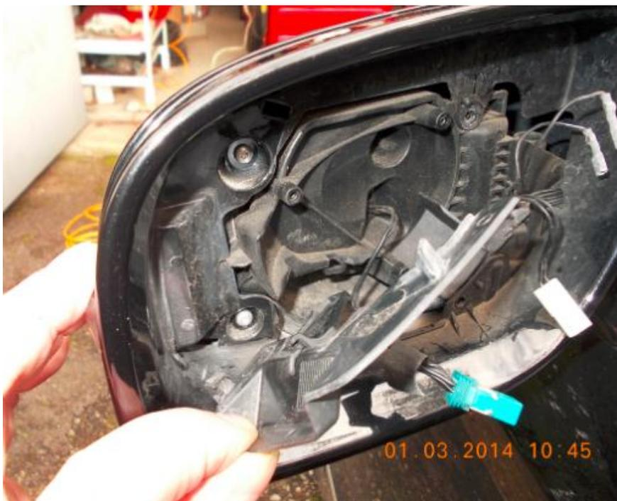
Nachdem die 4 Torx T10 Schrauben entfernt sind, kann die hintere Spiegelverkleidung / der Spiegelrahmen einfach mit der Hand abgenommen werden:
