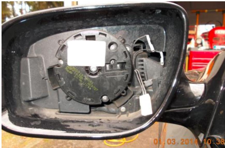
Nach dem Entfernen der 3 Torx T10 Schrauben, muss nun noch der elektrische Anschluss (blauer Stecker) gelöst und die linke Abdeckung ausgebaut werden. Die Abdeckung ist nur mit 2 Rastnasen eingerastet und kann mit dem kleinen Schraubendreher ausgeklipst werden.
