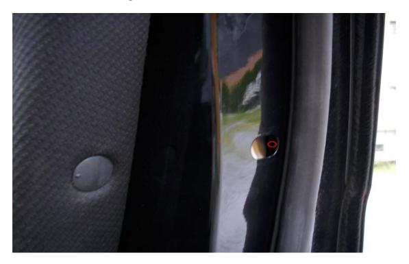
4. Mit dem lösen der Schraube kann man die Führung des Türgriffes abnehmen
