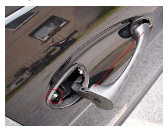
6. So sieht die neue Führung von unten aus, der Einbau erfolgt natürlich in umgekehrter Reihenfolge
