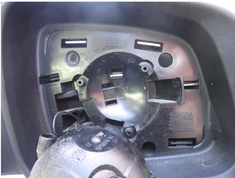
Bild 7 - Das sieht dann so aus. Nun die fünf oberen Spangen zum Ausrasten der Spiegelkappe nach unten drücken (ACHTUNG BRUCHGEFAHR!). Die beiden unteren Spangen halten die untere Spiegelverkleidung und sind nur interessant, wenn diese ausgebaut werden soll.
