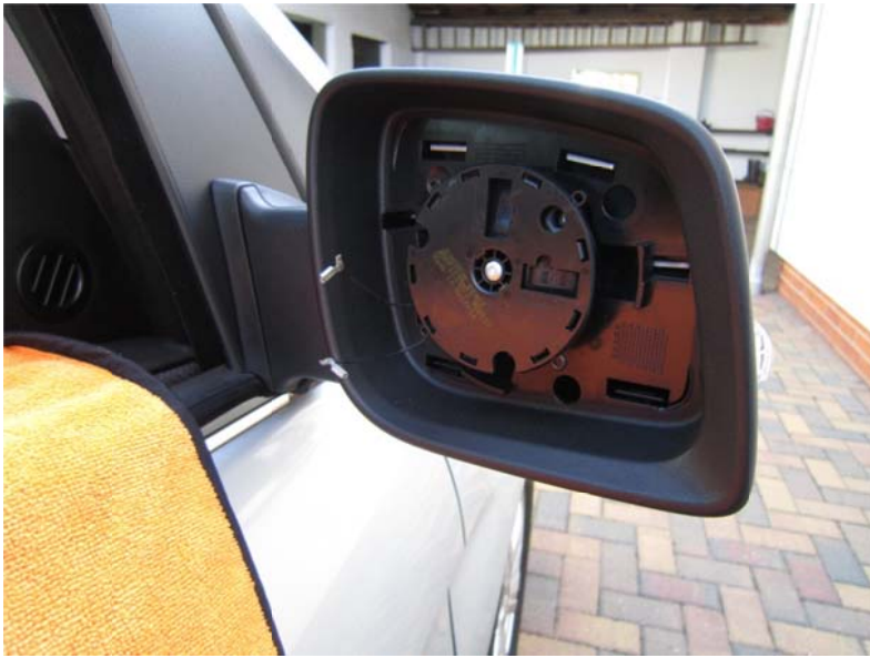
Bild 18 – Noch einmal kontrollieren, ob alles richtig eingerastet ist, dann die Kontakte der Spiegelheizung verbinden und das Glas einsetzen. Geht deutlich leichter als bei der Demontage.
