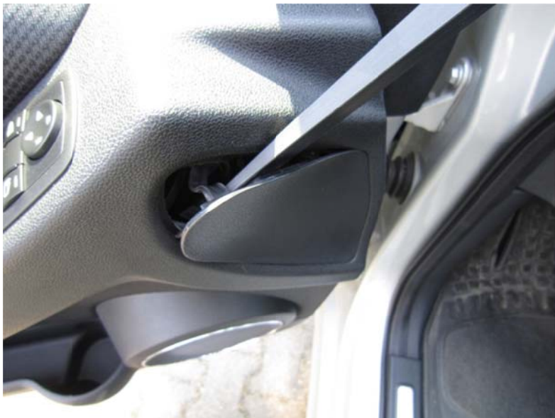
Bild 1 - Abdeckung in Fahrertür mit Langkeil entfernen.
