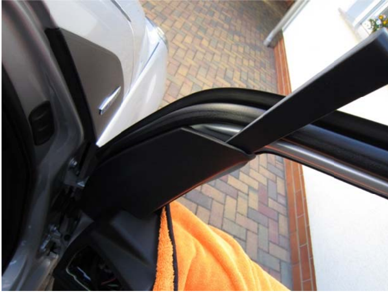
Bild 12 - So, der Spiegel ist entkernt und kann demontiert werden. Dazu die Verkleidung mittels Langkeil ausklipsen (2 Klips, brechen gerne, Ersatz bereithalten).
