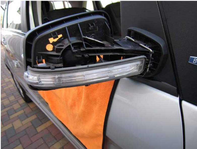
Bild 10 - Nun liegt die Blinkleuchte frei. Diese ist mit einem Rasthaken gesichert. Diesen ebenfalls ausklipsen.
