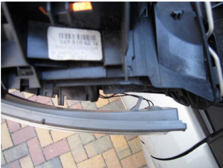
Bild 11 - Hier die Blinkleuchte abgezogen von oben, rechts erkennbar der Rasthaken. Jetzt nur noch den Stecker abziehen.
