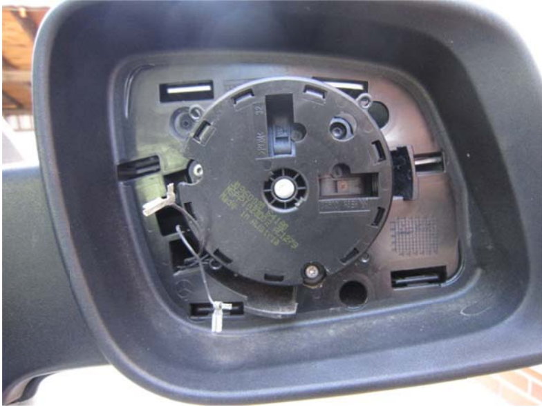
Bild 6 - Nun muss der Antrieb für die Spiegelglasverstellung entfernt werden, da sich eine Spange der Spiegelkappe genau dahinter befindet (Torx TX10).
