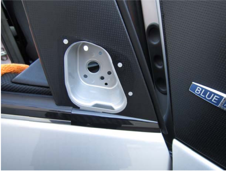
Bild 14 – Hier befand sich der alte Spiegel. Alles etwas säubern, und in umgekehrter Reihenfolge (nun kommt nichts Neues mehr, ich kürze daher etwas ab) wieder zusammenbauen.
