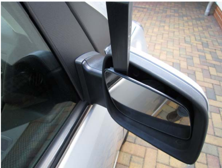
Bild 5 - Spiegel ganz nach unten fahren, dann das Spiegelglas mit Langkeil ausklipsen und vorsichtig heraushebeln (Bruchgefahr!). Steckkontakte von Spiegelheizung abziehen.
