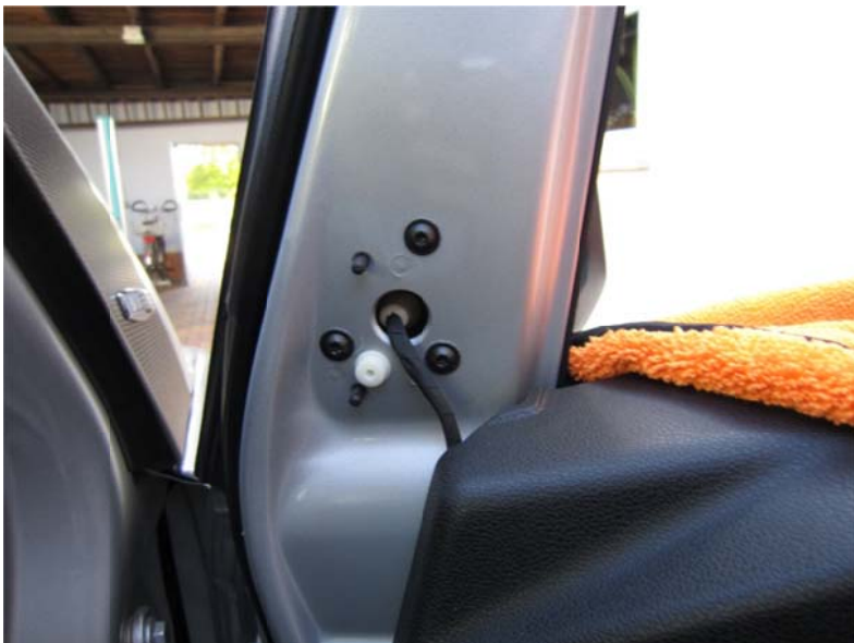
Bild 13 - Das ist so ein Bruchkandidat (weiß). Ich habe dafür ein spezielles Ziehwerkzeug (Eigenbau), man kann ihn aber auch ganz lieblos mit einer Zange herausziehen, und einen neuen Klip verwenden. Nun kommt wieder der Torx TX20 zum Einsatz – 3 Stück Schrauben herausdrehen, dabei den Spiegel außen festhalten! Stecker von Türsteuergerät abziehen, Spiegel abnehmen.
