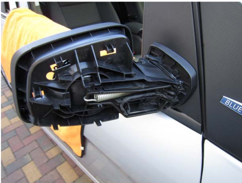
Bild 15 – neuer, elektrisch abklappbarer Spiegel ist dran, innen verschraubt und an das Türsteuergerät angesteckt.
