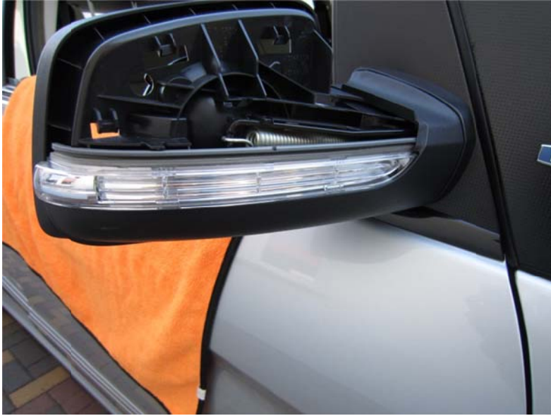
Bild 16 – Blinkleuchte, untere und innere Spiegelverkleidung sind montiert. Stecker von der Blinkleuchte nicht vergessen!
