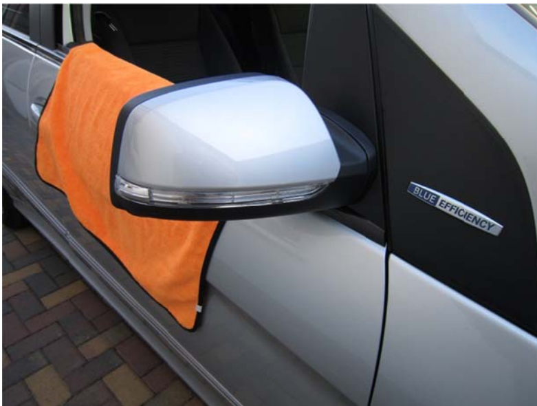
Bild 17 – Spiegelkappe aufsetzen und einrasten, so sieht das schon fast fertig aus.
