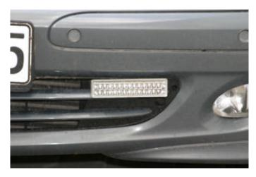
die "Schlitze" im mittleren Teil der Schürze, dort speziell die äußeren Stellen, die nach innem hin geschlossen sind und daher nicht der Kühlluftzufuhr dienen.
