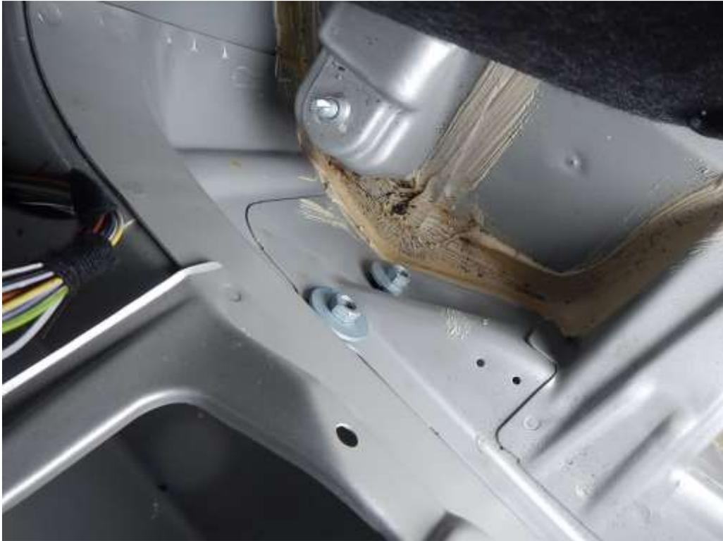
*Abbildung 5 – Stoßfängerverschraubung 5 x abschrauben.*
