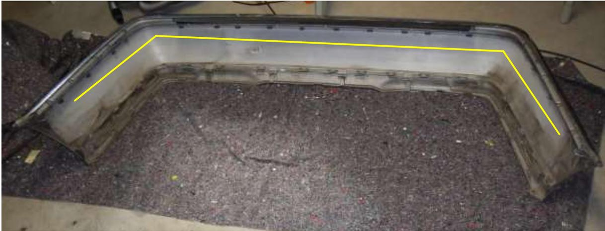
Abbildung 9 – Antennenfläche reinigen.
