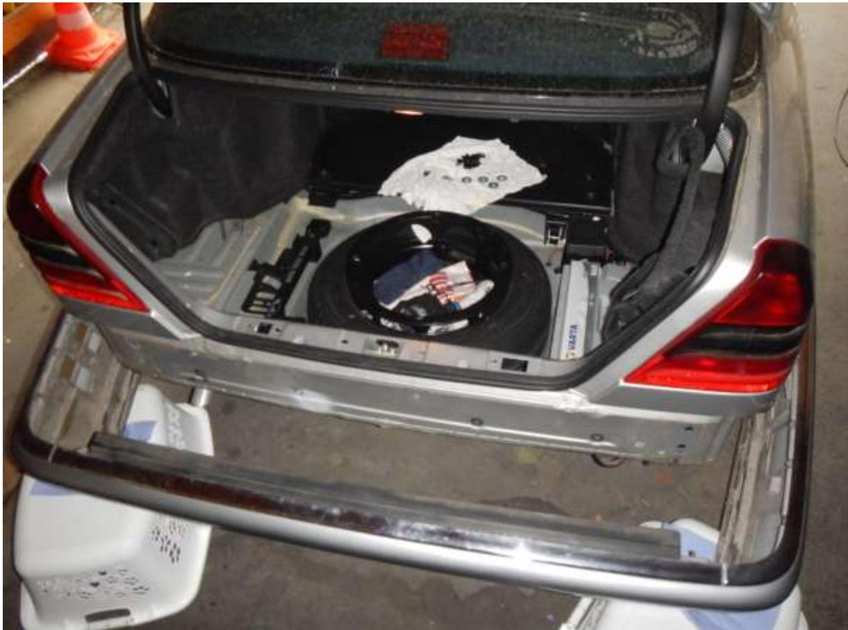
Abbildung 6 – Stossfänger nach hinten abziehen und aushängen.
