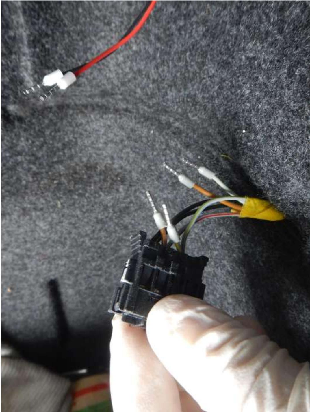
*Abbildung 18 – Verbindungskabel crimpen.*
