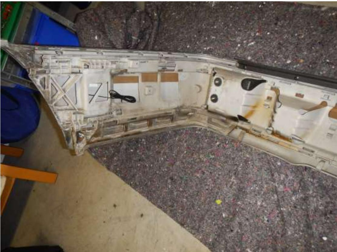
*Abbildung 14 – Stoßfänger komplettieren inklusive Antenne und Anschlusskabel.*
