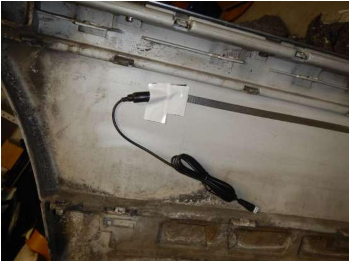
*Abbildung 12 – Steckverbindung mit Klebeband schützen.*
