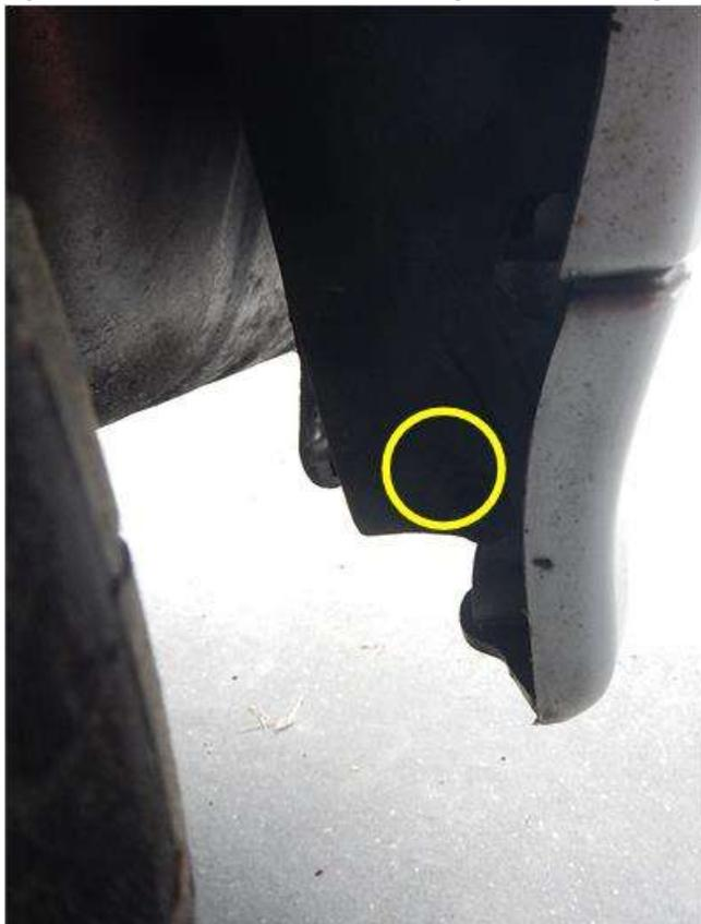
*Abbildung 3 – Spreizdübel im Radkasten links hinten lösen*
