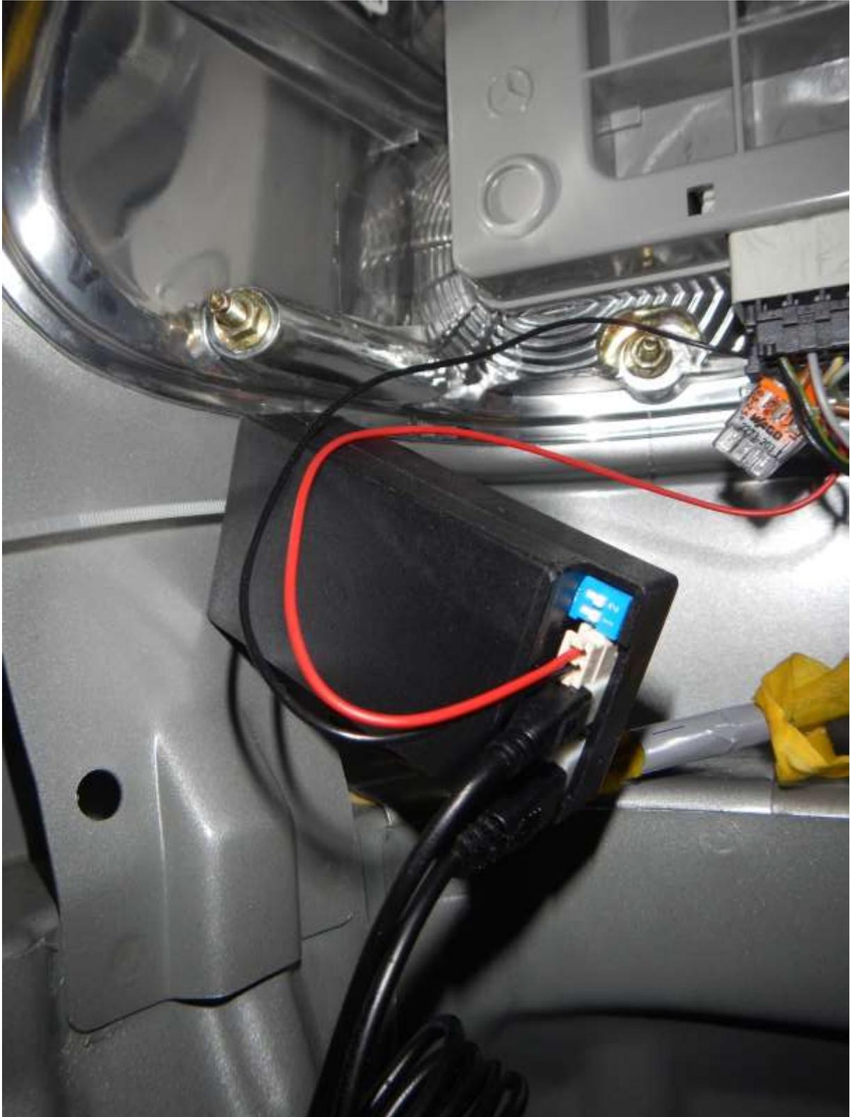
Abbildung 21 – Steuergerät anklemmen.
