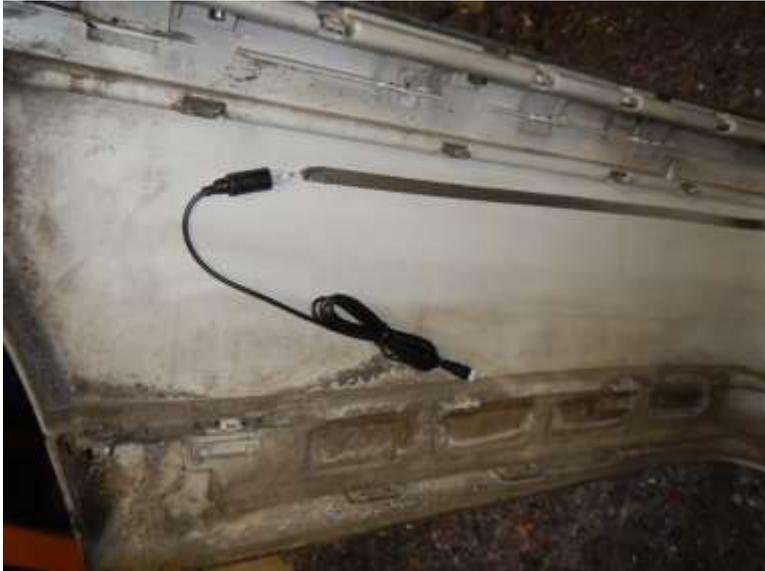
*Abbildung 11 – Verbindungskabel anstecken.*
