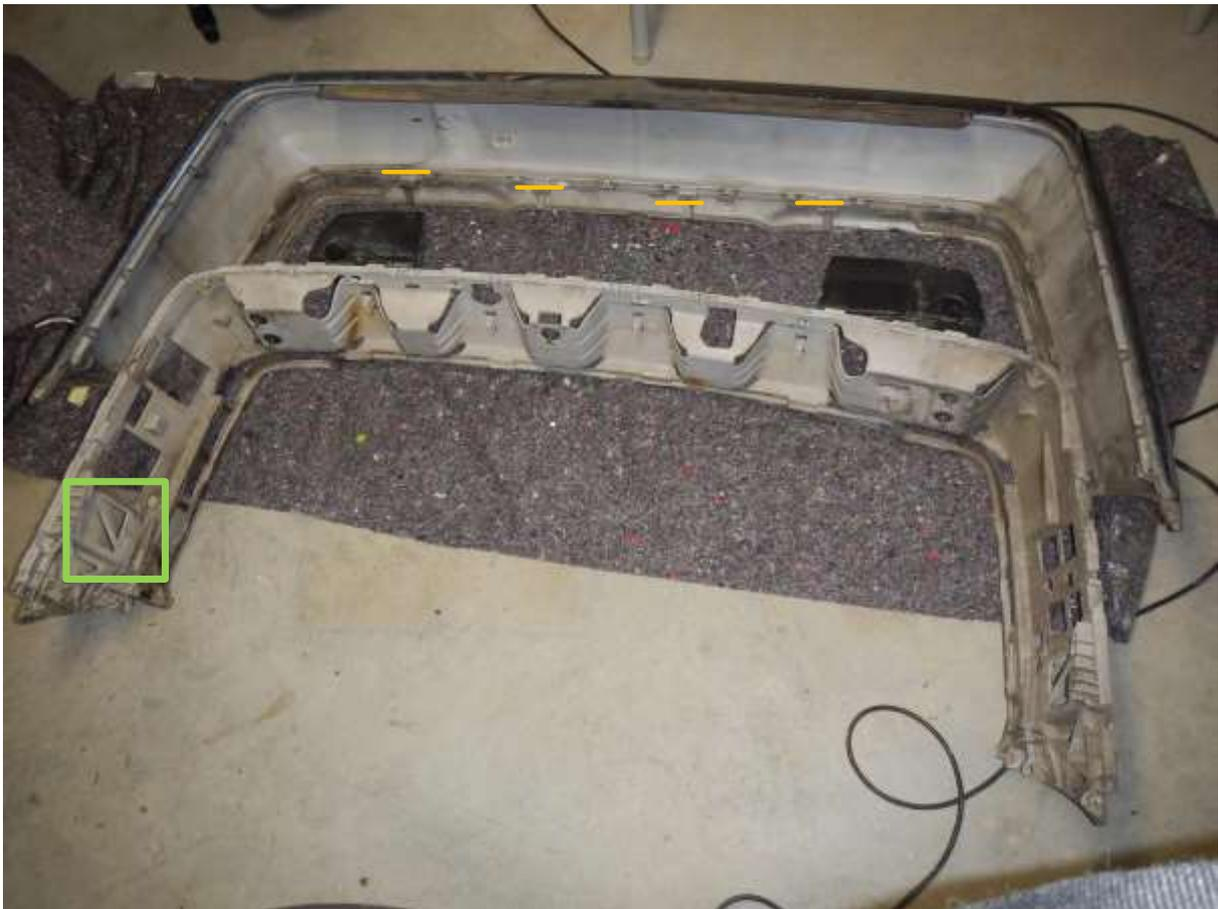
Abbildung 8 – Stossstange mit Außenteil und abgetrenntem Träger.
