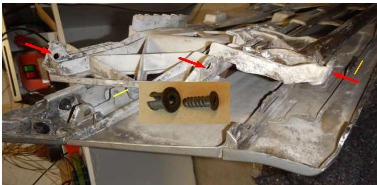
Abbildung 7 – Spreizdübel abschrauben und Innenträger vom Außenteil lösen.
