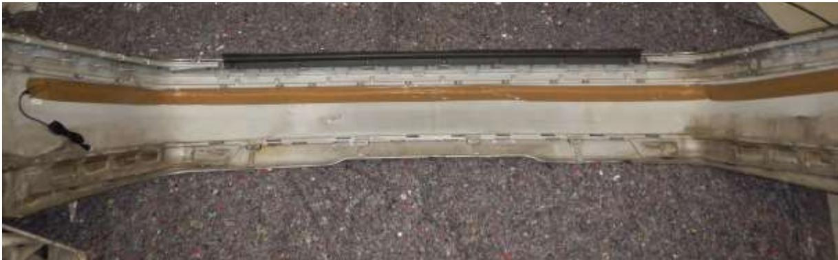
*Abbildung 13 – Antenne abkleben.*
