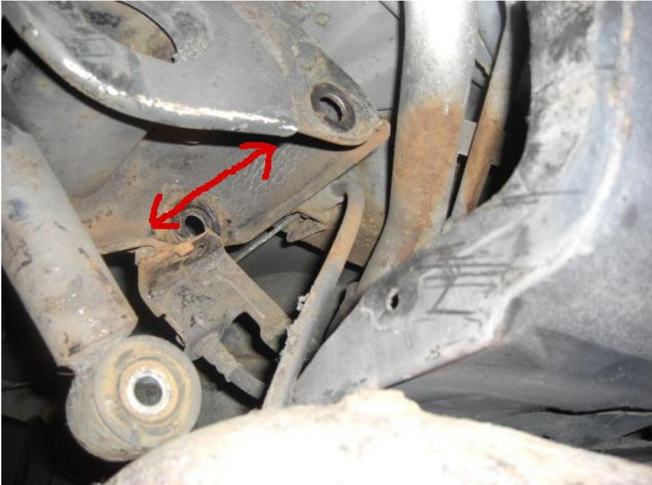
Den Längsträger am Stoßdämpfer einfädeln und in die Halterung einsetzen. Die längere Schraube von außen einschieben und die kleine von innen.
