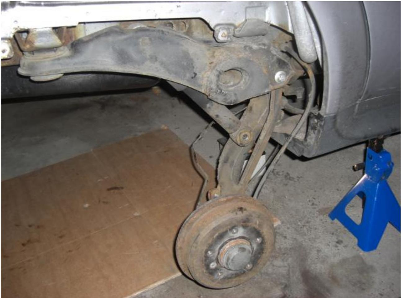
**Tipp:** Um den Stabilisator zu entfernen müssen von beiden Seiten die Stoßdämpfer gelöst werden. Daher ist es ratsam vor Beginn der Demontage der Längsträgers auf einer Seite auf beiden Seiten die Stoßdämpfer und die Feder zu demontieren.
