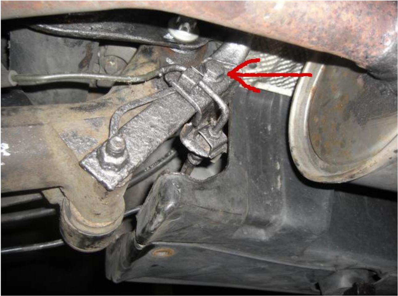
Wagenheber herunterlassen und die Feder rausnehmen. Der Längsträger hängt jetzt frei rum.
