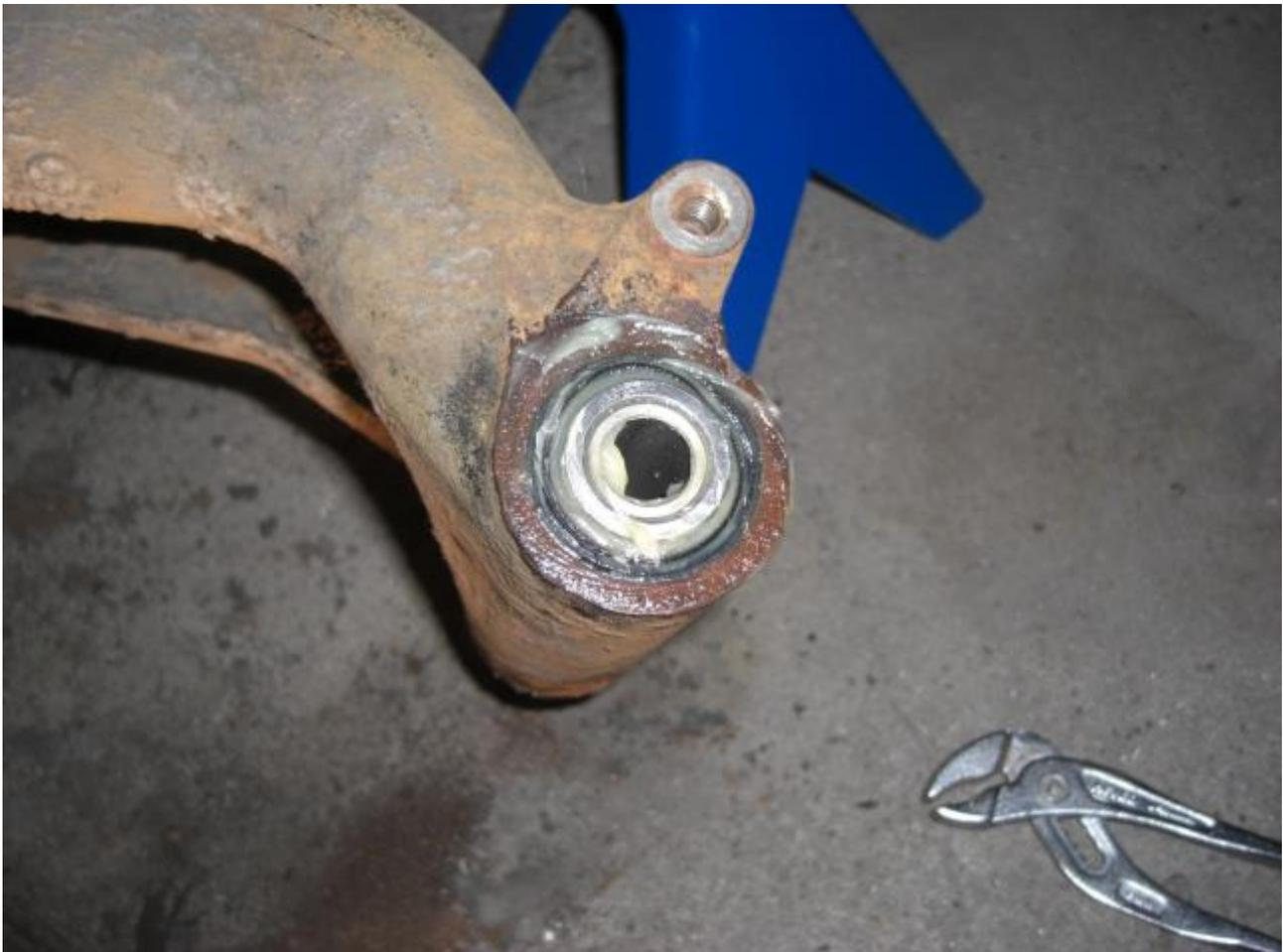
Oft passt der instandgesetzte Längsträger nicht in die U-Halterung rein. Vor dem Einbauen und Verschrauben ist es erforderlich die Bleche der U-Halterung ein wenig zu erweitern.
