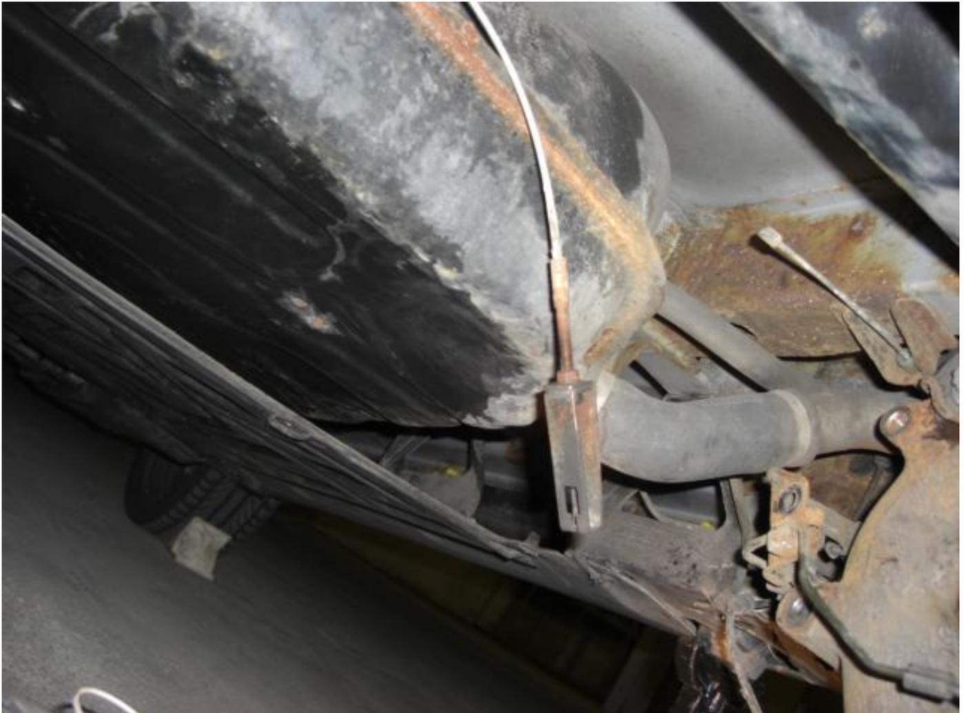
Die Bremsleitungen vom Träger lösen (Kunststofföse).
