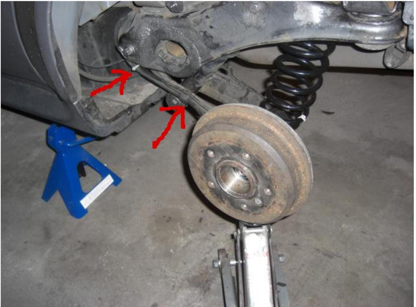
Die Feder entspannen. Unter die Trommel den Wagenheber setzen und anheben so dass der Stoßdämpfer gelöst werden kann.
